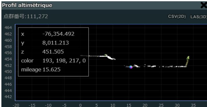
左図のように、指定した断面情報が表示され、選択した点に対応する座標値や色情報等が表示されます。この断面は、『CSV (2D)』と『LAS (3D)』の形式で保存することができます。
